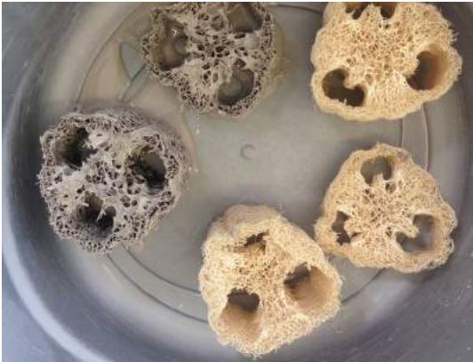
Piezas de estropajo bañadas en barbotina. Pruebas con diferentes capas.
