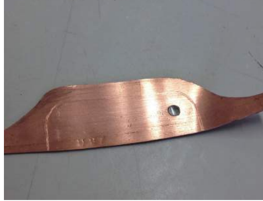
Prototipo de soporte del lente para Iphone.
