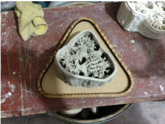
Base estandar para las piezas. Se debe tener en cuenta la contracción de la cerámica y un espacio prudente entre la pieza y la base.
