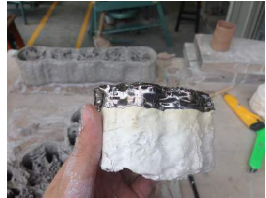
Esmalte cerámico metalizado para borde.
