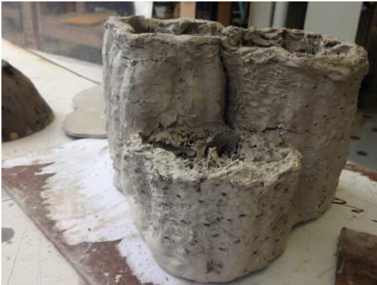
La piezas se agrietan durante el proceso de secado debido a la contracción y choque del estropajo y la barbotina.
