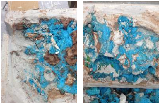
Molde en yeso para sacar módulos en cerámica: Dañado debido a la textura porosa
