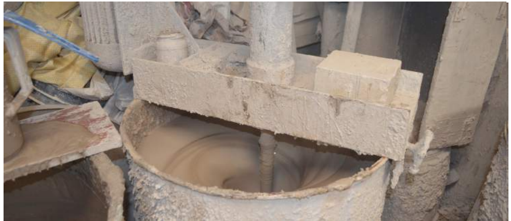
Mezcla barbotina y esmalte para sumergir el estropajo.
