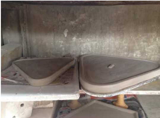
Bases en arcilla a partir de un molde en yeso y modelo en madera.
