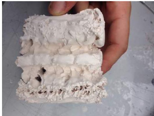
Al quemar la pieza, el estropajo desaparece casi totalmente.
