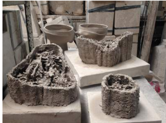
Secado de las piezas sobre placas de yeso que absorben la humedad para generar bordes planos
