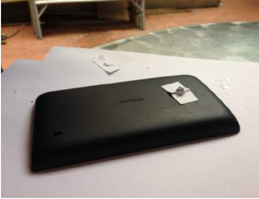
El lente sale de la punta de un laser, converge la luz en un punto y esto hace que amplifique la imagen generada por la cámara del celular.
